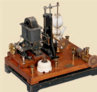
Motorbetriebener Quecksilberunterbrecher von Max Kohl, um 1900 Schätzpreis 5.000 – 7.000 €
